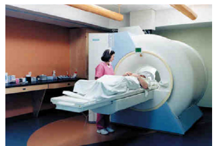
รูปที่ 6 ฮีเลียมเหลวใช้หล่อเย็นวัสดุตัวนำยิ่งยวดที่ใช้ในการสร้างสนามแม่เหล็กที่มีความเข้มสูงในอุปกรณ์ถ่ายภาพอวัยวะภายในของร่างกาย ที่เรียกว่า Magnetic Resonance Imaging (MRI)
